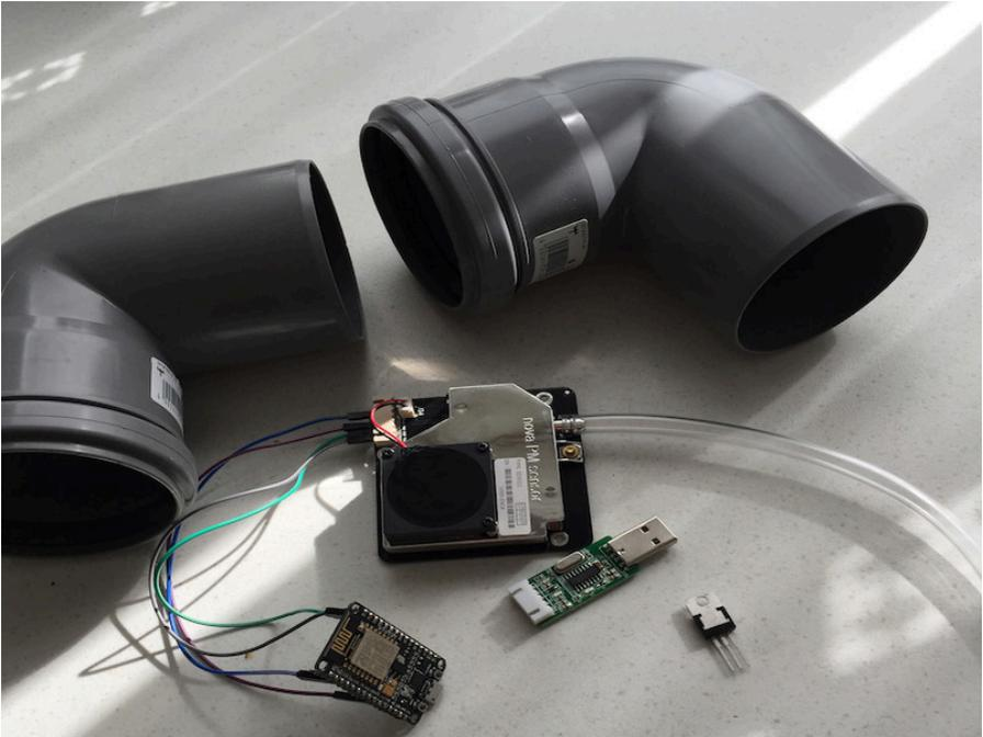
*Teile eines Feinstaubsensors*
